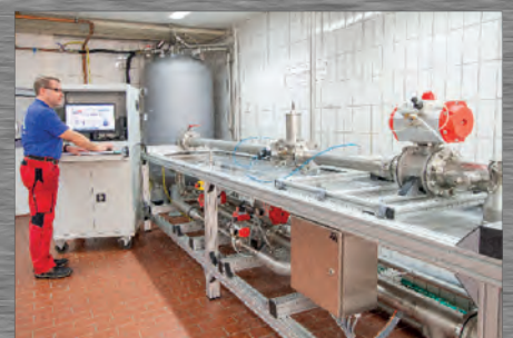
Armaturenprüfstand Valve Test Lab
